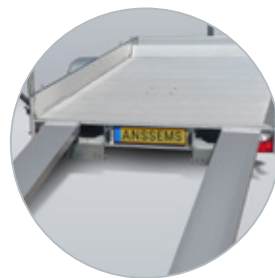
Rampes intégrées dans leur casier
