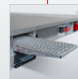
Rampes intégrées sous le plancher
